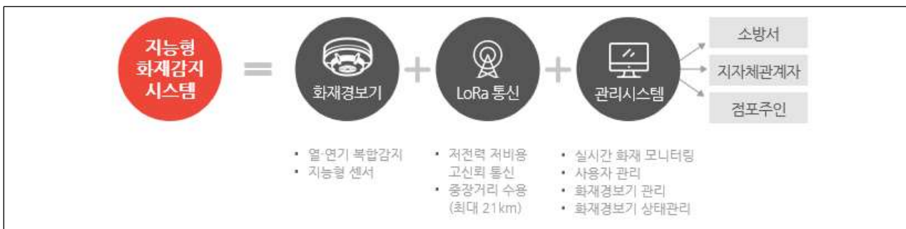
(그림 II-2-19) IoT기반 화재감지시스템 개념도(예시:전통시장)
