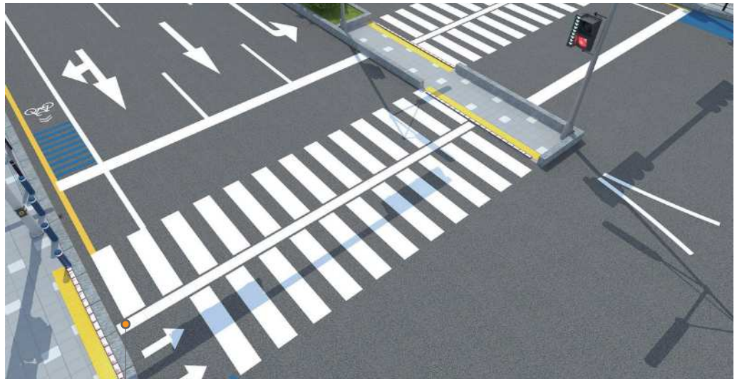
시각장애인이 안전하게 보행할 수 있도록 선형 블록과 동일한 위치에 에스코트 존 설치 (돌기가 있는 블록 마감)
