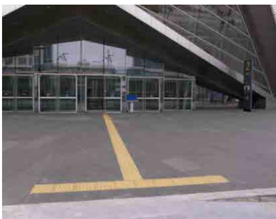
〈대지경계 - 주출입구(안내시설)의 점자블록 설치 이미지〉
