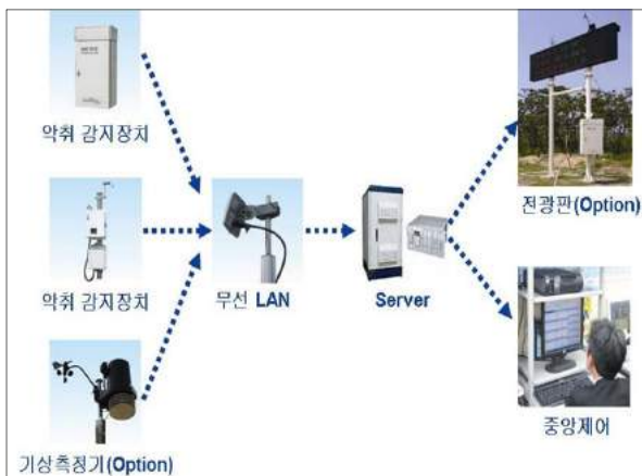
〈그림 II-8-2〉 실시간 악취모니터링 시스템 개념
