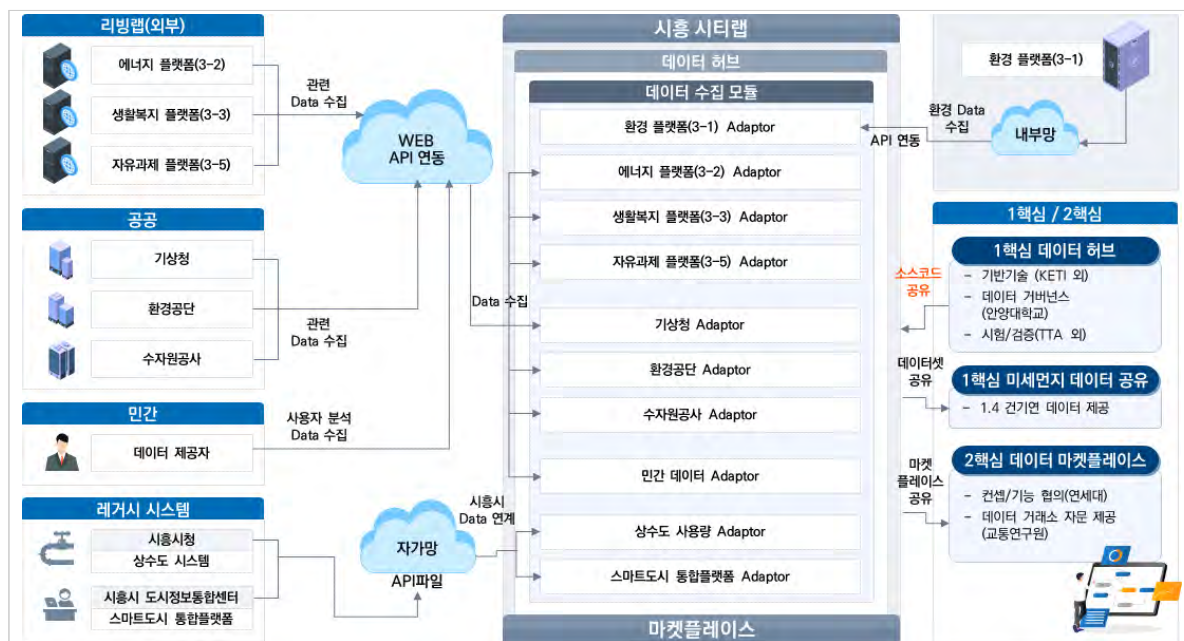
[그림 IV-35] 시흥시 데이터 수집 시스템 구성도
