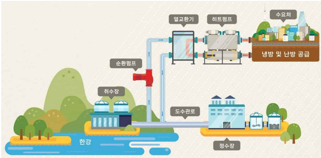
〈그림 199〉 도수관로 수열에너지 활용 계통도
