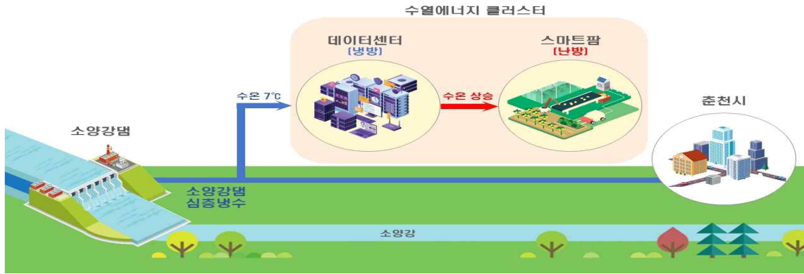
〈그림 201〉 강원 수열에너지 집적단지 수열 활용 개요도
