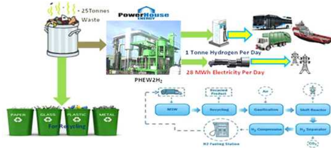
〈그림 243〉 폐자원을 활용한 수소생산 개념도(Powerhouse Energy)
