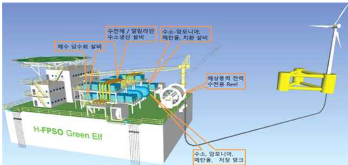
〈그림 244〉 1MW급 부유식 해양 수소생산 선박
