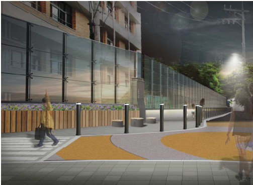
· 투명방음벽 설치 및 라인조명 매입
