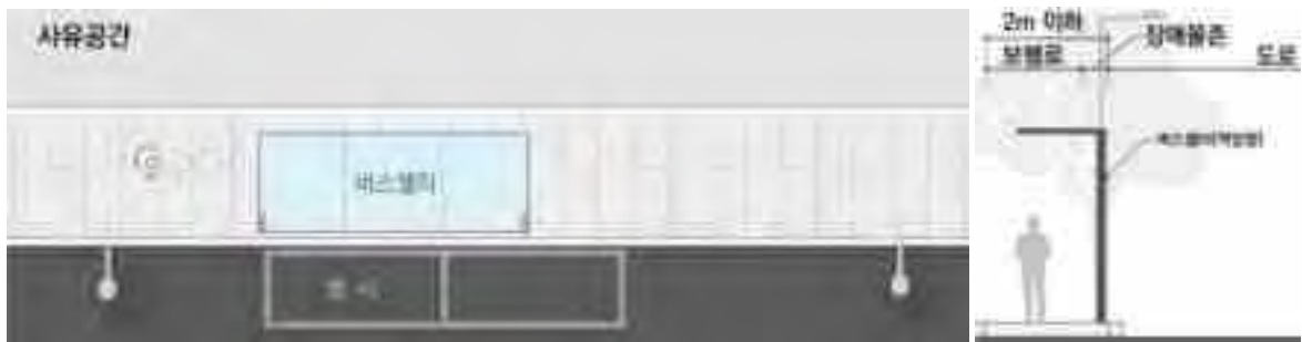
역방향 버스쉘터 설치
