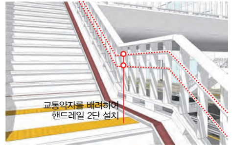
[ 그림 5-128 2단 안전바 설치 기준 ]
