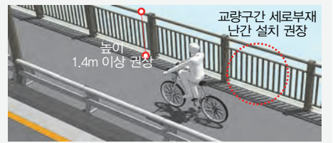
[ 그림 5-78 교량구간 자전거용 방호울타리 설치 ]
