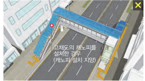
[그림 5-126 보도육교 설치 기준(색채 및 재료)]
