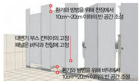
[그림 5-191 대변기 부스 설치 기준]
