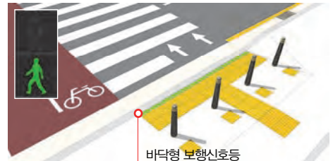
[그림 5-97 바닥형 보행신호등 설치 기준]
