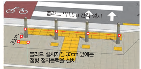
[그림 5-17 볼라드 설치 기준]
