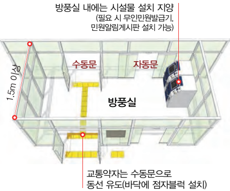
[ 그림 5-171 자동문과 수동문을 동시에 설치한 경우 ]
