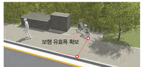
[그림 5-11 점유 면적이 넓은 공공시설물 설치 예시]
