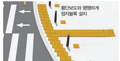
[그림 5-89 곡선부 점자블록 설치 기준]
