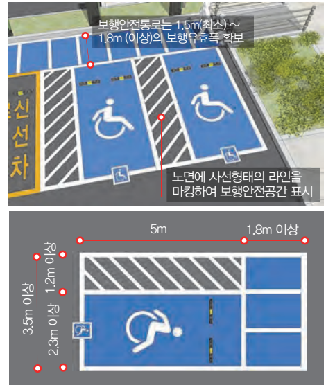
[ 그림 5-168 장애인 주차구역 설치 기준 ]
