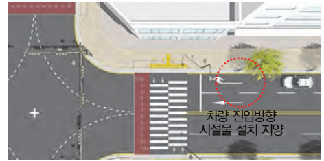
[그림 5-92 횡단보도 주변 시설물 설치 기준]
