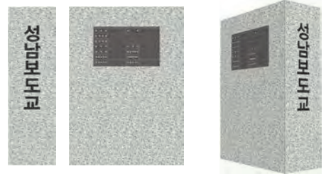
[그림 5-107 교명주 및 교량 제원 패널 설치 예시]
