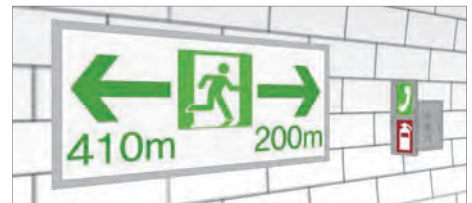
[ 그림 5-123 안전시설 정보표지 예시 ]
