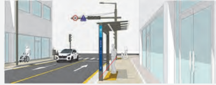
[그림 5-44 폭 2m 미만 보도 버스승차대 설치]
