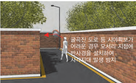
[ 그림 5-67 시야 확보가 어려운 장소는 반사경을 설치 ]
