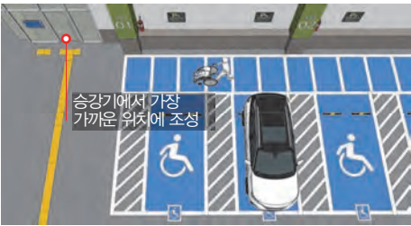
[ 그림 5-161 옥내주차장 내 장애인 전용주차구역 조성 예시 ]
