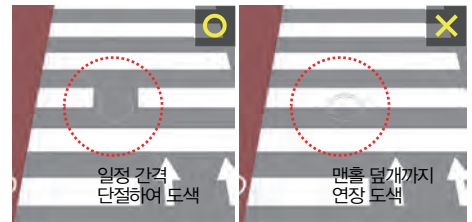
[그림 5-93 횡단보도 내 맨홀 설치 예시]
