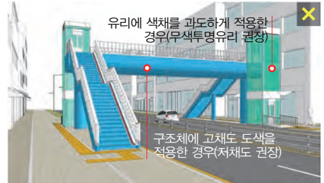
[그림 5-127 보도육교 설치 기준(색채 및 재료)]
