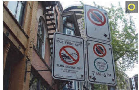
[그림 5-24 여러 개의 정보표지를 통합화·규격화하여 설치한 경우]
