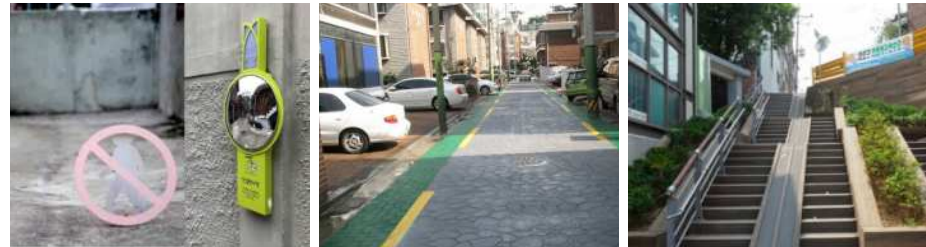
· 건물 이격공간 및 접근통제(반사경 설치) · 보차도 구분 및 주차구역 표시 · 경사로 계단 바닥 및 안전손잡이 설치
