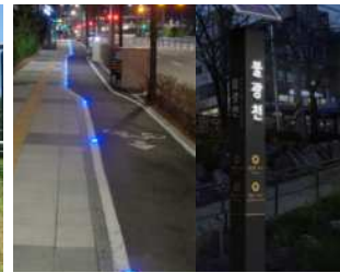
· 안전운행 유도 조명 설치 (바닥조명, 가로등, LED안내판)
