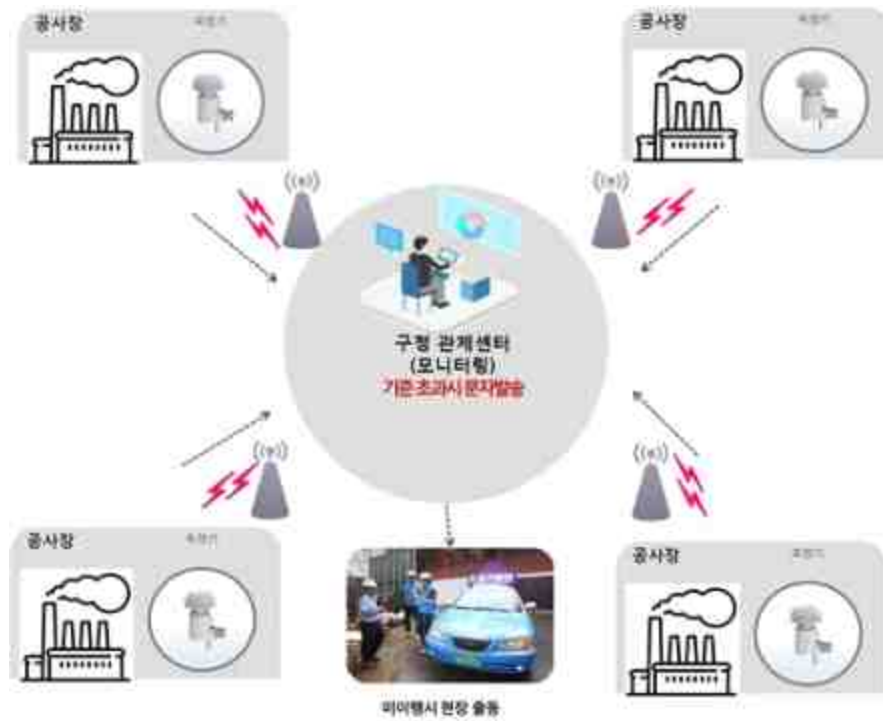
그림 124. IoT 기반 공사장 소음관리 사례(서울 강서구)
