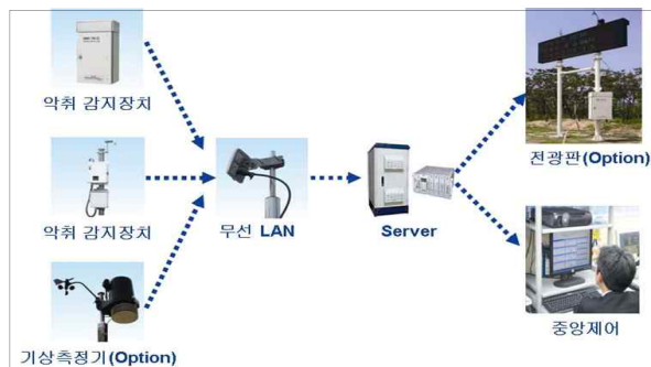
〈그림 II-5-12〉 실시간 악취모니터링 시스템 개념
