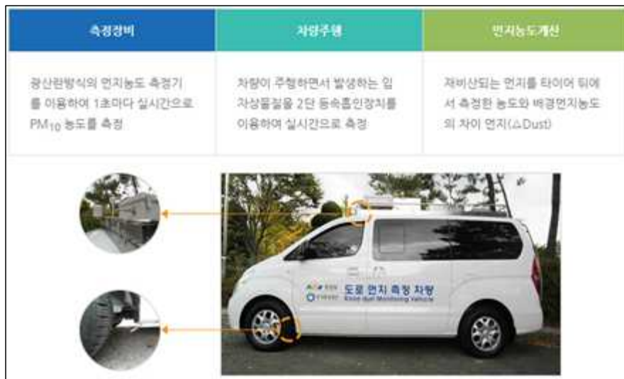
<그림 II-3-8> 도로 재비산먼지 이동측정 시스템 원리
