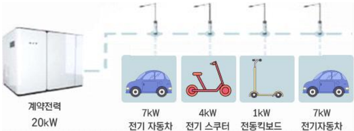
[그림 5-5] 양천구 가로등 활용 전기차 및 스마트 e-모빌리티 충전기
