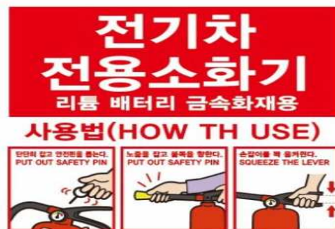
<그림6-12> 전기자동차 전용 소화기
