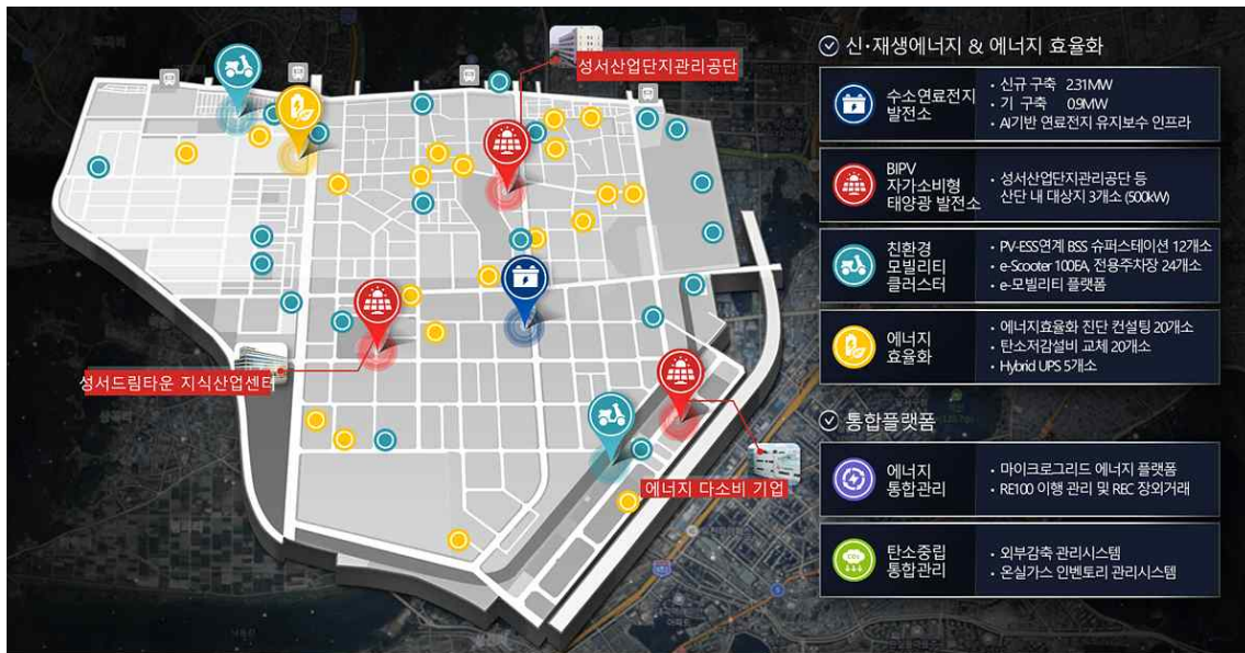
그림 6-6. 대구 성서산업단지 에너지 자급자족형 인프라 구축사업 개요도
