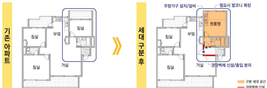
[그림 6-16] 기존 주택의 세대 구분 설치 예시도
