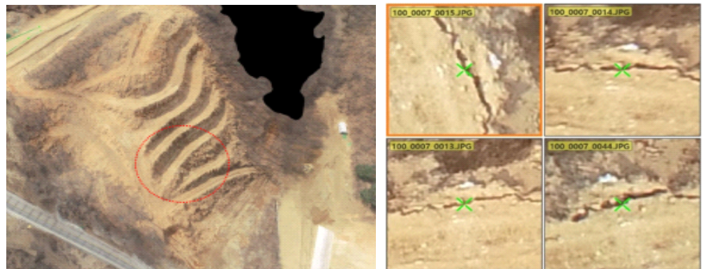
[그림 V-10] 드론을 활용한 비탈면 촬영(좌) 및 비탈면에 발생한 균열확인(우)
