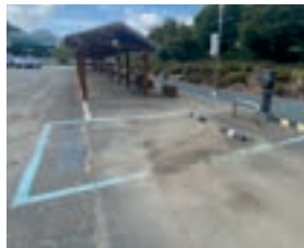
▲ 시인성이 낮은 노면 표지 및 관련 안내표지의 부재
