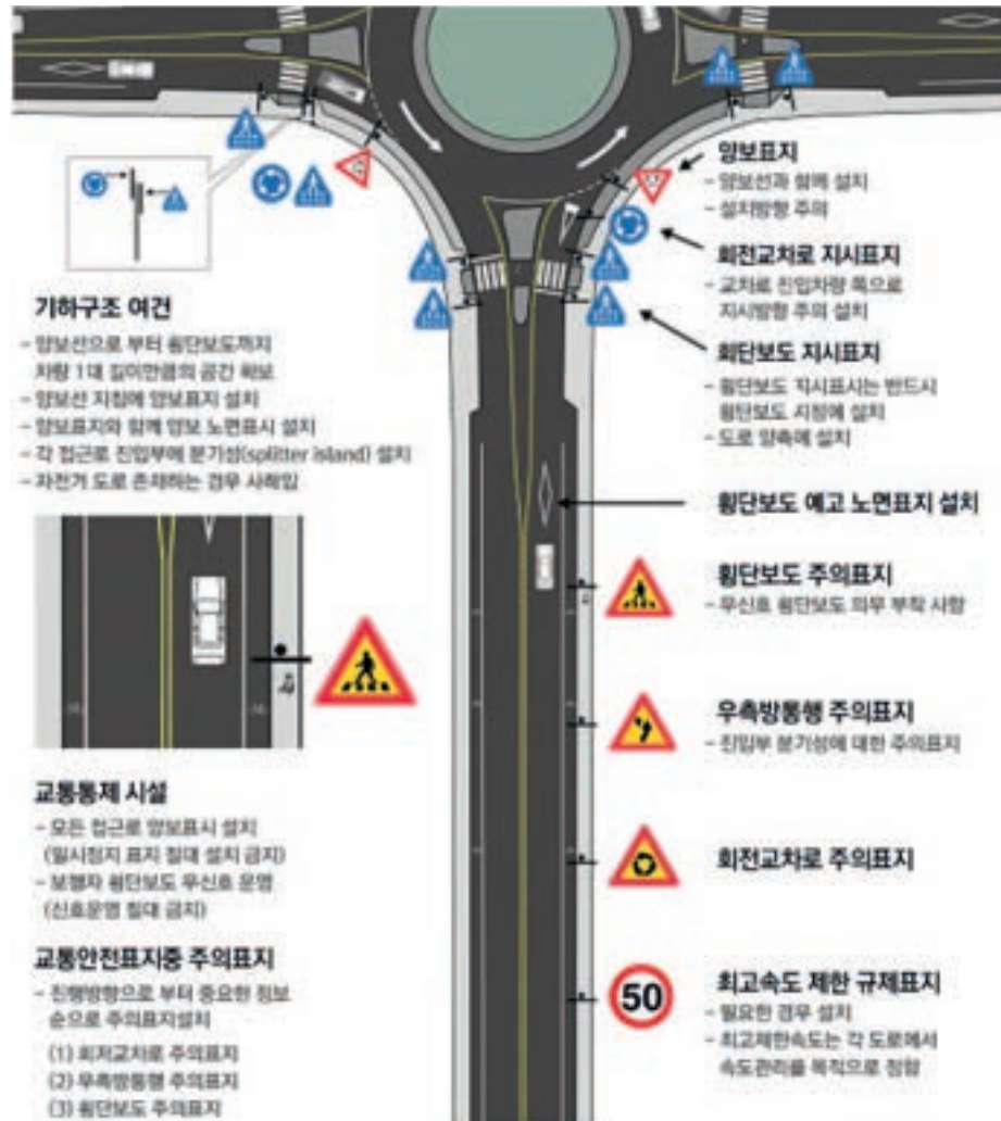
(회전교차로 지시표지 설치 예)
