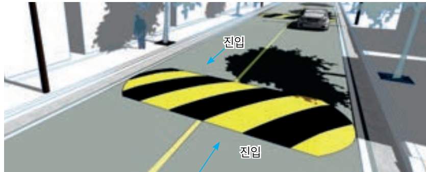
▲ 과속방지턱 양면 설치
