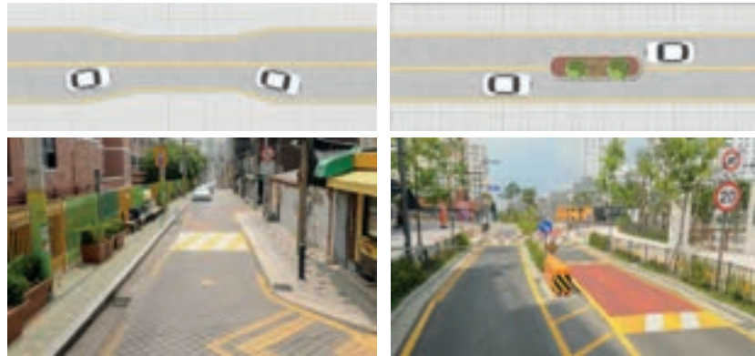
▲ 차로폭 좁힘 종류 (교통 정온화 설계 및 유지관리 지침 마련 연구 최종보고서, 국토교통부, 2018)
