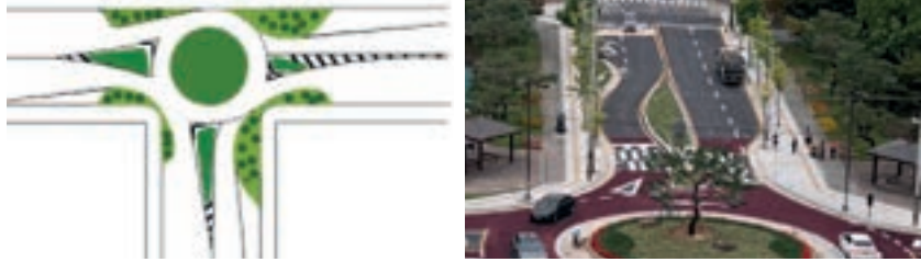
▲ 회전교차로 진입부 도로 정온화 기법 예시(「회전교차로 설계 지침」, 국토교통부, 2022) 및 사진
