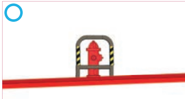
▲ 올바른 설치 방법(경사와 상관없이 수직으로 설치)
