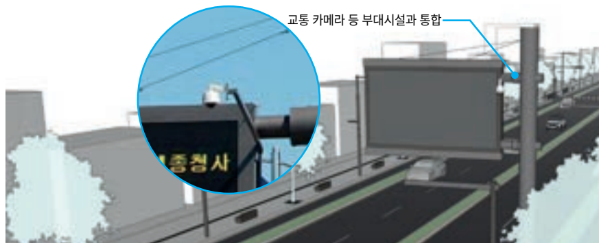
▲ 교통용 CCTV와 통합 설치
