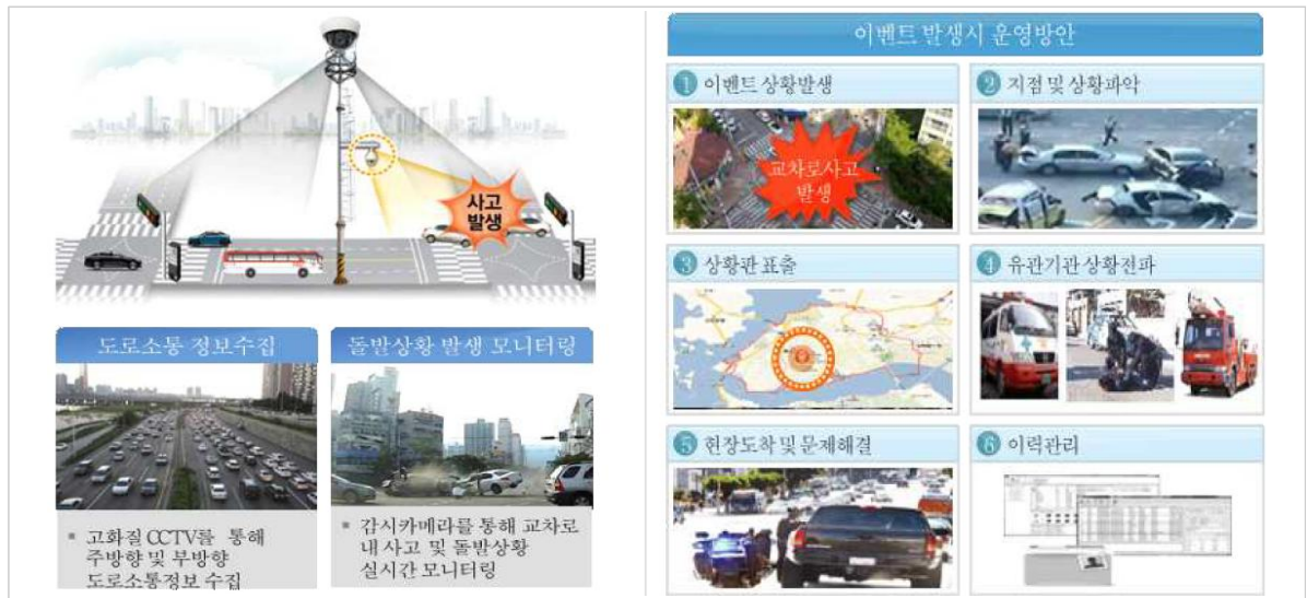
[그림 II -96] 돌발상황 관리 구성도 출처 : 2021~22년 구미시 지능형교통체계(ITS) 구축사업 준공보고서, 구미시, 2022
