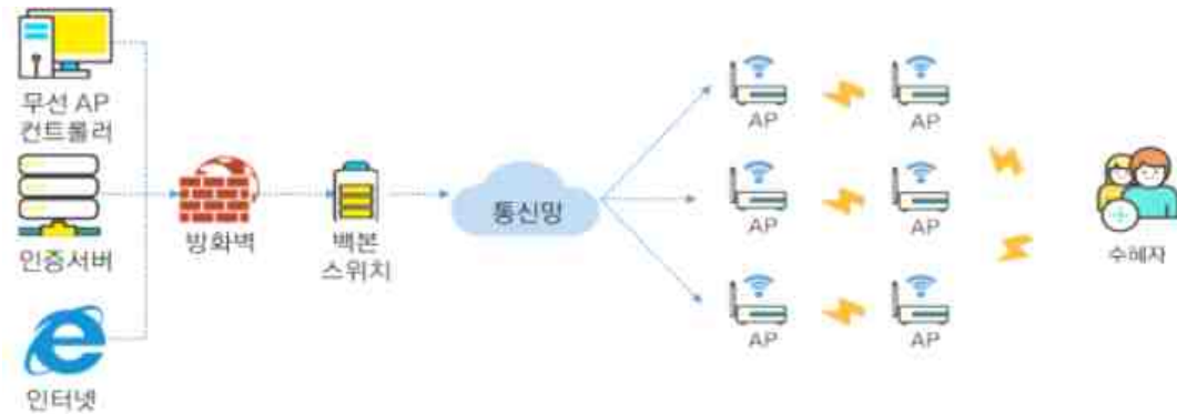
[그림4-7] Wi-Fi 망 구성 방안 예시도
