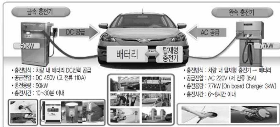
[그림 IV-26] 급·완속충전기 개요(예시)
