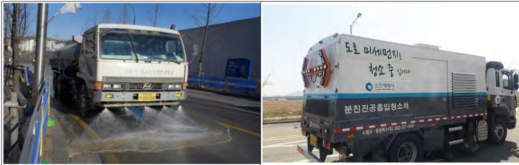
< 공사장, 도로 재비산먼지 청소차 운영사례 >
