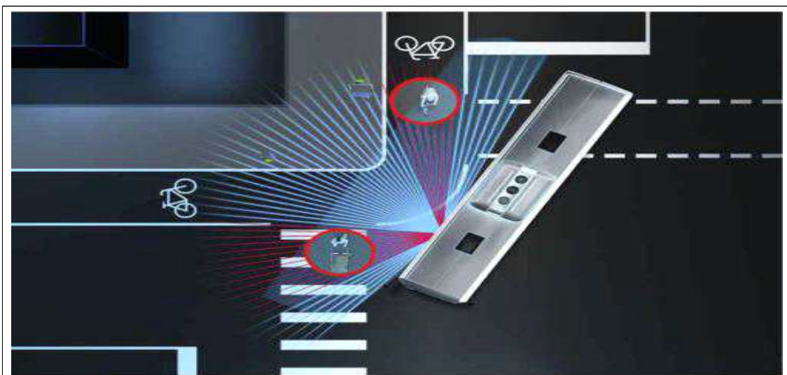
[그림 6-1] 측방 감지센서 (Sideguard Assist) 예시
