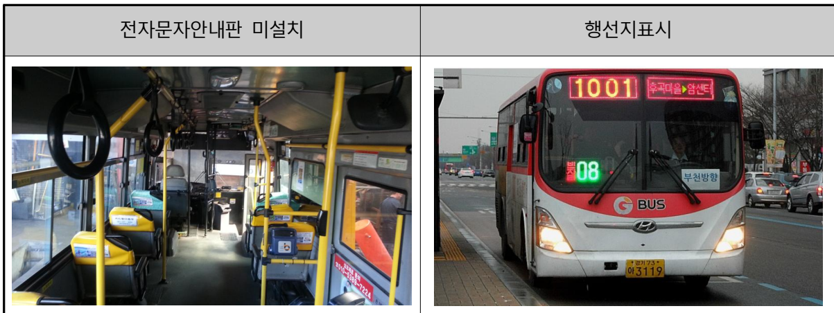
〈 그림 3-5 〉 전자문자안내판 미설치 및 행선지표시
