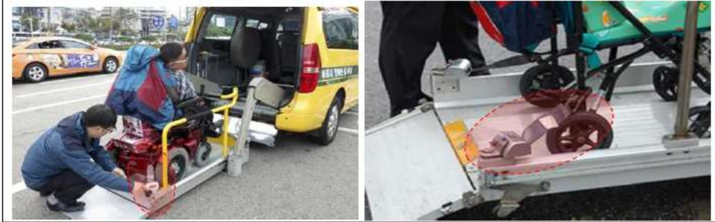
《승강설비 내 안전장치》
