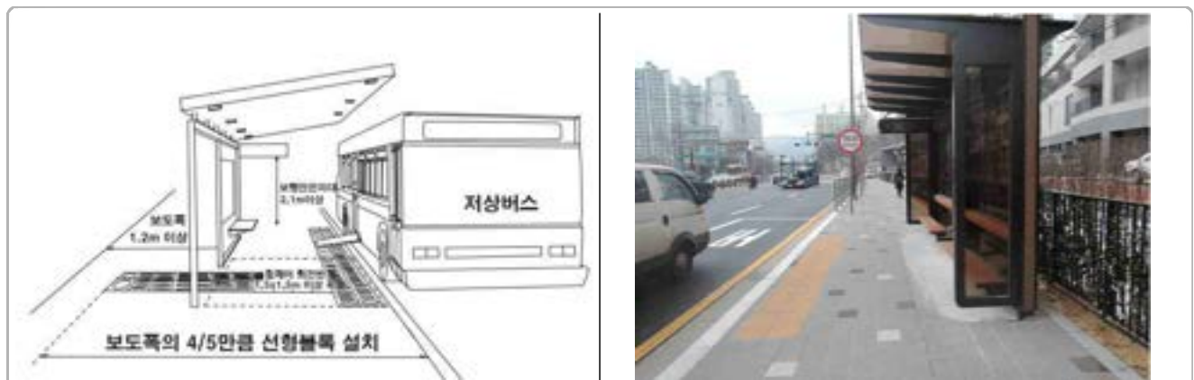
〈그림 5-7〉 버스정류장 설치 기준
