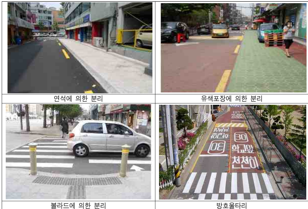
<그림 5-26> 보행자·차량 분리 시설 설치 사례
