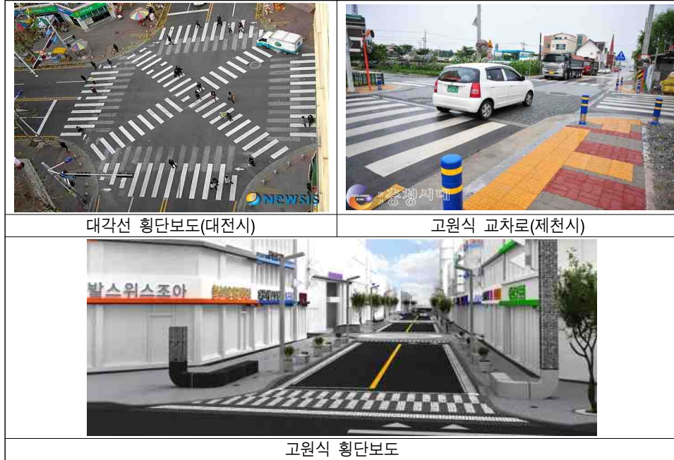
<그림 5-21> 대각선 횡단보도 및 고원식 교차로 · 횡단보도 설치 사례
