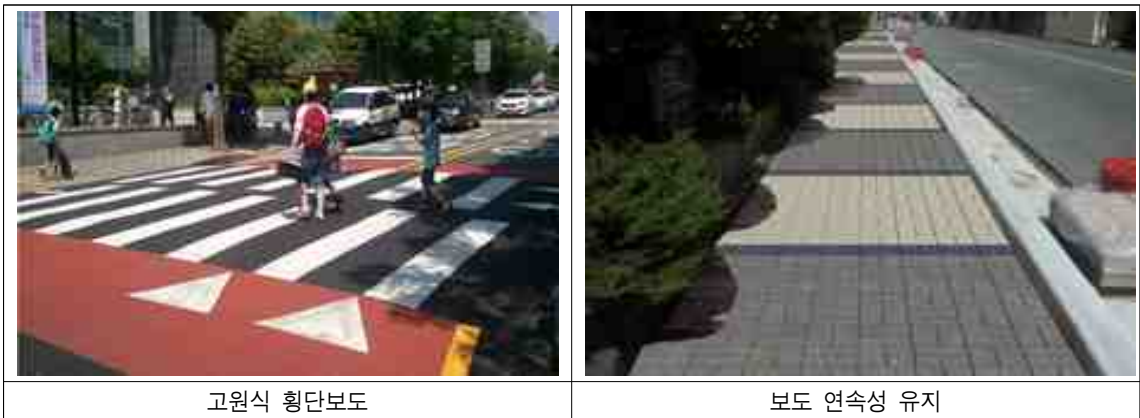
<그림 5-12> 고원식 횡단보도 및 보도 연속성 유지 사례
