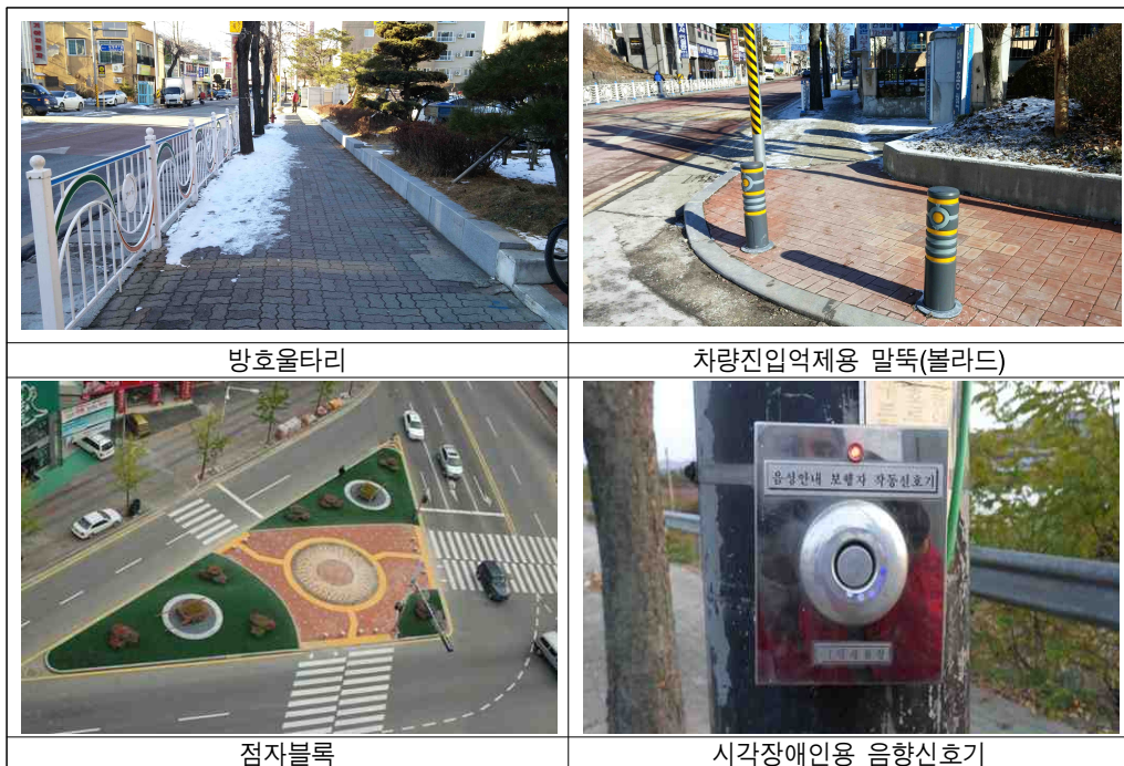
<그림 5-22> 보행자 안전시설 설치 사례
