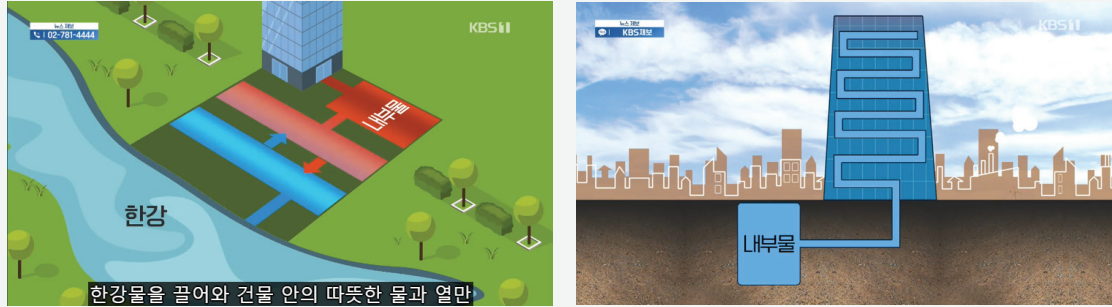
[그림 5-30] 롯데월드타워 수열에너지 이용 원리
