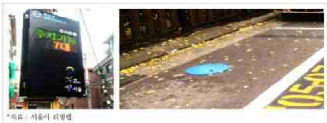
[그림 IV-97] (좌) 독산4동 골목길에 설치된 전광판 (우) 주차구역 주차감지보드
